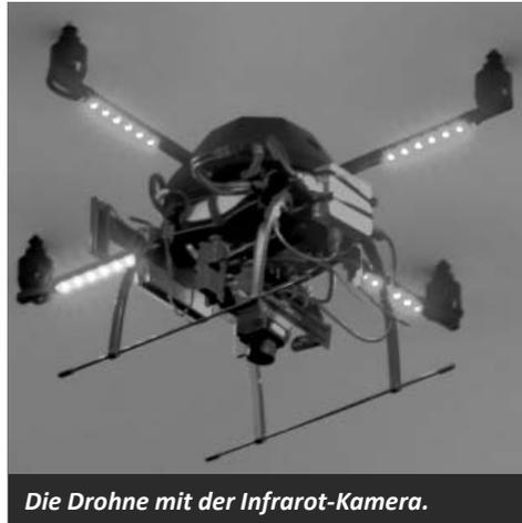
Die Drohne mit der Infrarot-Kamera.
