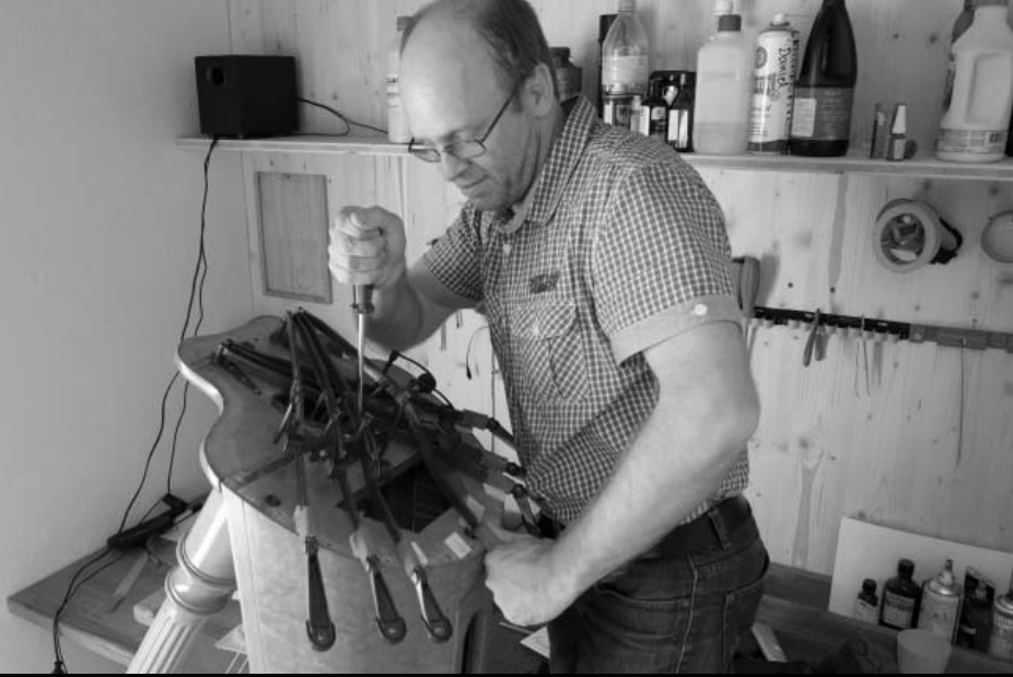
Daniel Zurlinden bei der Reparatur einer Konzertharfe. Gut zu sehen ist die Pedalmechanik.
