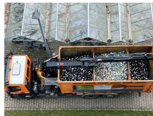
Mehrkammer-Fahrzeug für Altglas
